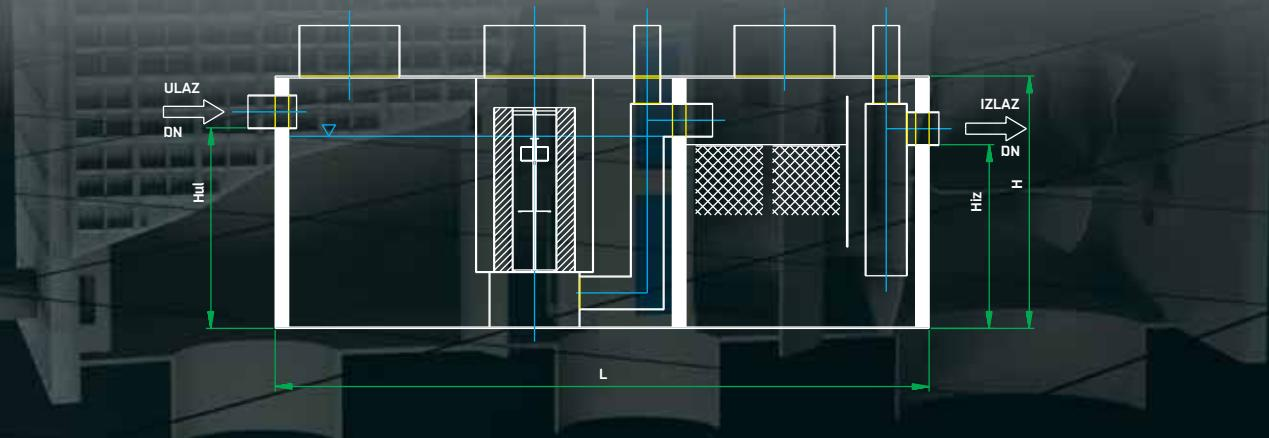
Separatori ulja BP OLEX L/KF/SF namijenjeni su za vodoopskrbnu području sa srednjom količinom mulja. Služe za pročišćavanje oborinske ili procesne vode zagađene zauljenim tekućinama. Nakon pročišćavanja voda se može ispušтati u prirodni recipijent.
