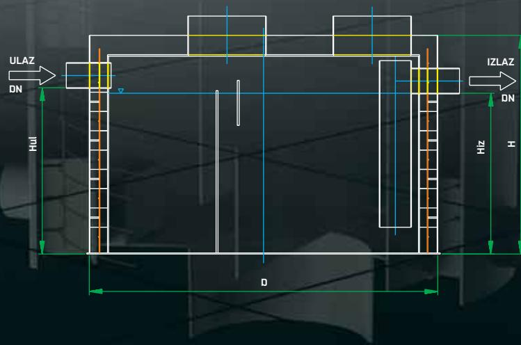
Separatori masti služe za prikupljanje organskih ulja i masti koje sadrži otpadna voda iz kuhinja, prehrambene industrije, klaonica, itd. Odvajanjem masti sprječava se začepljenje sustava kanalizacije i zagađenje vodotoka.
