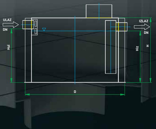
Upotrebljavaju se za pročišćavanje otpadnih voda s parkirališta, benzinskih crpki, itd., odnosno u slučajevima kada je prisutno zagađivanje oborinske ili procesne vode zauljenim tekućinama, a recipient je kolektor-kanalizacija. Rade na principu razlike specifičnih težina tekućina.
