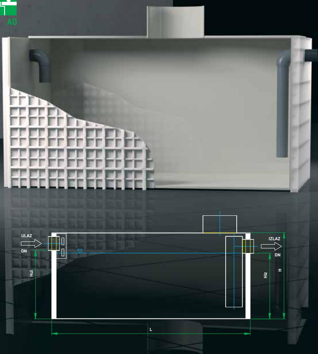
Upotrebljavaju se za pročišćavanje otpadnih voda s parkirališta, benzinskih crpki, itd., odnosno u slučajevima kada je prisutno zagadivanje oborinske ili procesne vode zauljenim tekućinama, a recipient je kolektor-kanalizacija. Rade na principu razlike specifičnih težina tekućina.
